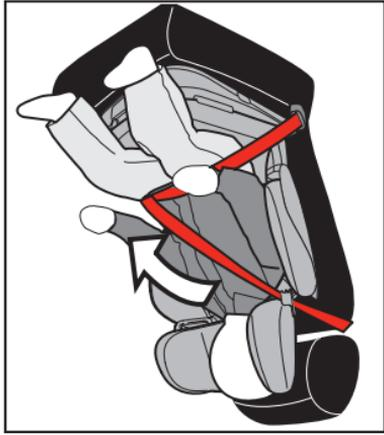
2. Attacher la ceinture de sécurité du véhicule jusqu'au dé clic. Placer les deux sangles de la ceinture comme indiqué sur la figure.
